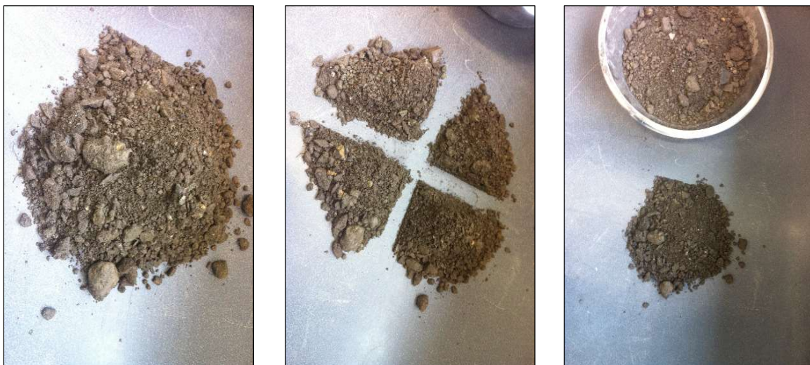
Abbildung 9 Probenteilung nach dem Kegelverfahren (Probe GR-A-P1)
