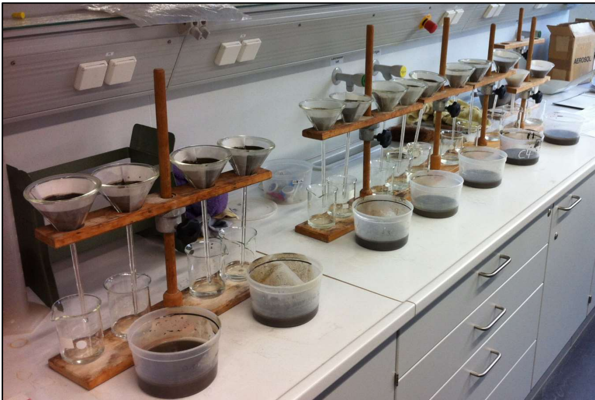
Abbildung 10, Filtrieren der suspendierten Stoffe mittels Papierfilter
